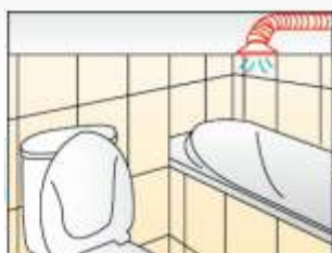
浴室廁所抽送風
